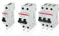
Os minidisjuntores protegem as instalações contra sobrecarga e curtos-circuitos, garantindo a confiabilidade e segurança para operação. O System pro M compact da série S200 consiste de dispositivos limitadores de corrente para proteção contra sobrecorrente. Eles possuem dois mecanismos de disparo diferentes, o mecanismo de disparo térmico, retardado para proteção contra sobrecarga e o mecanismo de disparo magnético para proteção contra curtos-circuitos.
