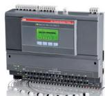
O Monitor de Arco™ TVOC-2 detecta arcos rapidamente e dispara o disjuntor. Usando luz como condição principal, ele dispara instantaneamente. Graças a essa vantagem funcional, ele age antes de todas as demais proteções e atrasos, o que é crucial quando o tempo de reação deve ser mantido na casa dos milissegundos. O Monitor de Arco consiste numa central e no sensor óptico usado para detectar arcos.
